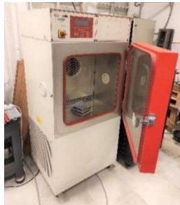
Figura 4.3.- Cámara climática y su diagrama de bloques
